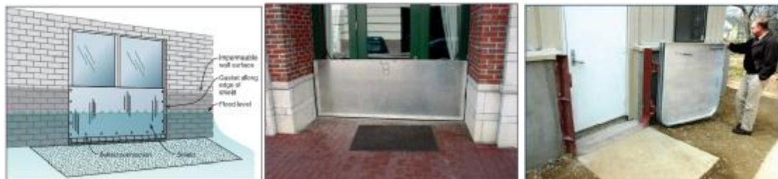
Hình 6: Cửa chặn nước (flood shield) trong thiết kế và thực tế
